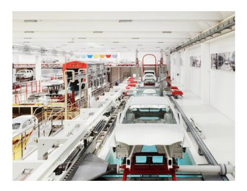
**Geico** è un'azienda del **settore automotive** che progetta e realizza impianti chiavi in mano per la verniciatura delle scocche auto.
